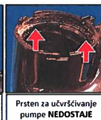
OŠTEĆENI prsten za učvršćivanje pumpe
