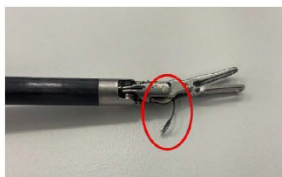
Slika H: Slomljeni kabel
