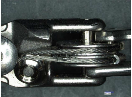
Slika D: 20x povećanje pohabanog kabela za držanje instrumenta da Vinci Xi
