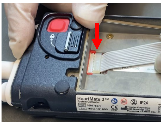
Slika 1: Spajanje trakastog kabela rezervne baterije
