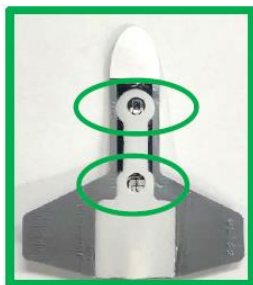
Slika 2: Senzori za odrasle/pedijatriju TruSignal bez utjecaja s čistim emiterima i detektorima.
