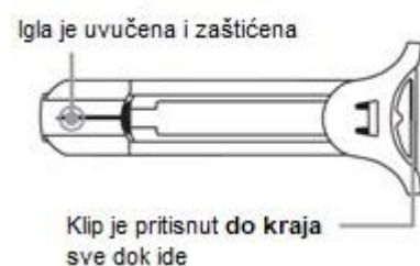
Slika 2. Napunjena štrcaljka i sigurnosni uređaj nakon upotrebe.
